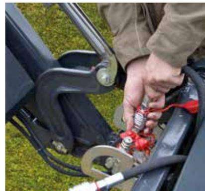
**3** Spajanje hidrauličkog priključka.
