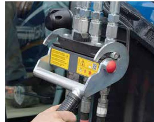
**2** S Hydro-Fixom se svi hidraulički vodovi mogu spojiti na traktor odjednom. Prednji utovarivač se lagano podiže kako bi se zatim za zaključavanje učvrstio u kuku za hvatanje klizne tračnice.
